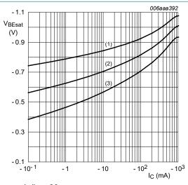
$I_{\rm C}/I_{\rm B} = 20$ (1)  $T_{\rm amb} = -55~{\rm ^{\circ}C}$ (2)  $T_{\rm amb} = 25~{\rm ^{\circ}C}$ (3)  $T_{\rm amb} = 100~{\rm ^{\circ}C}$
