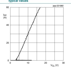
$t_{\rm r}$  = 600 ps  $t_{\rm p}$  = 5 ns; Very-Fast Transmission Line Pulse (VF-TLP)
