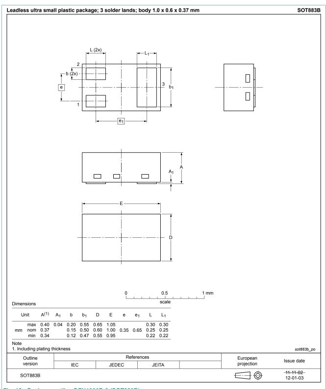
Fig. 12. Package outline DFN1006B-3 (SOT883B)
