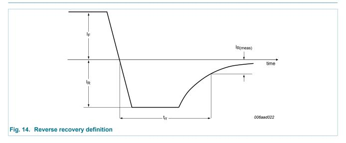
40 V, 2 A low VF MEGA Schottky barrier rectifier
