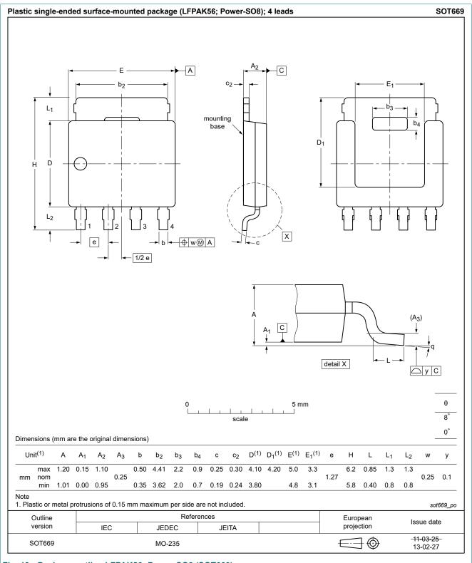
Fig. 19. Package outline LFPAK56; Power-SO8 (SOT669)
